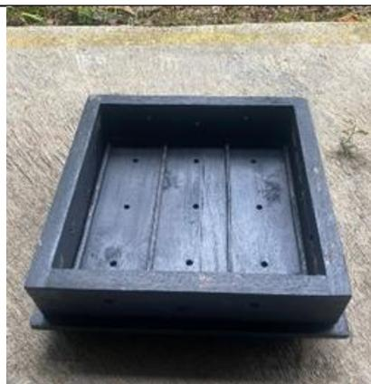
Gambar 15. Hasil pembuatan cetakan tahu
