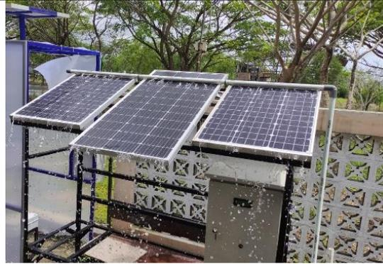
Gambar 7. Sistem Pendingin menggunakan Air
